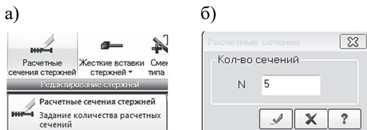
Рис. 2.41. Задание дополнительных расчетных сечений КЭ:
